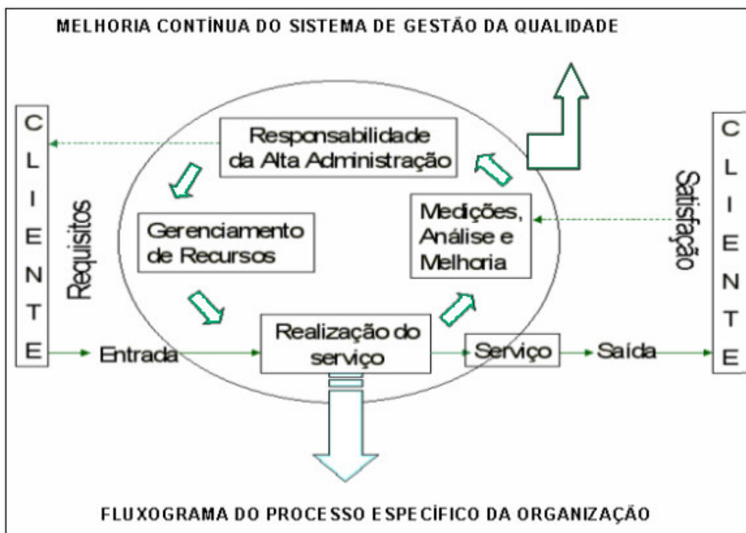
Figura 17: Modelo de um Sistema de Gestão da Qualidade baseado em processos numa empresa de serviços.
