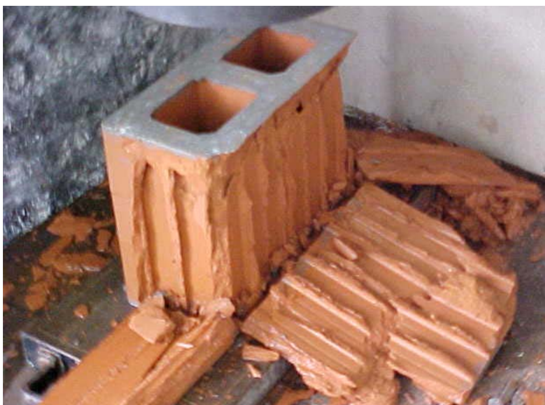
Figura 15 – Ensaio de compressão realizado no bloco
