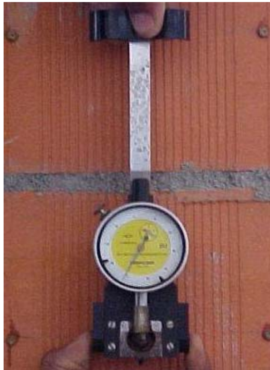
Figura 13 – Aparelho usado para medir o deslocamento relativo entre dois pontos no prisma
