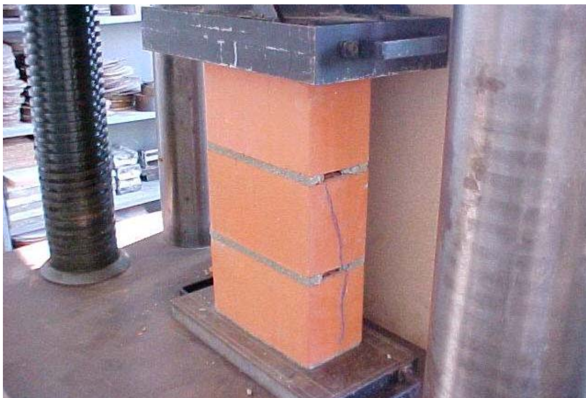
Figura 35 – Fissura inicial em prisma na condição FS
