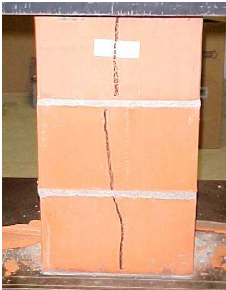
Figura 33– Fissura em prisma na condição CS
