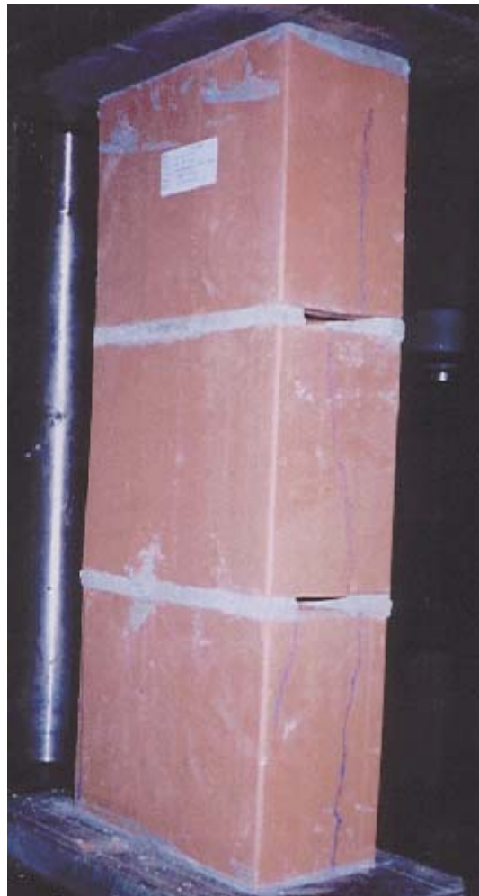
Figura 34 - Fissura em prisma na condição FS
