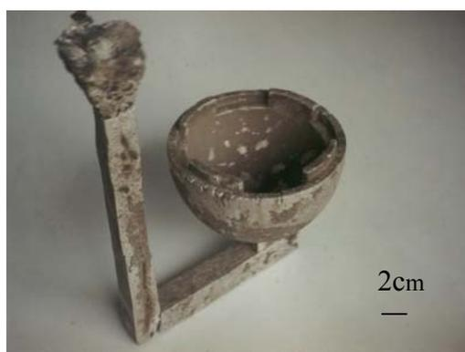
Figura 4.21 – Semi-esfera com bom acabamento, obtida na 3ª série de fusões
