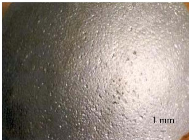
Figura 4.9 – Semi-esfera sem pintura com boa sanidade
