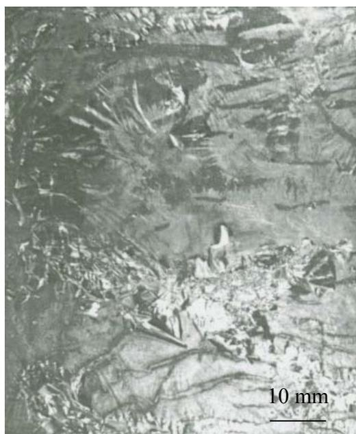
Figura 2.16– Aspecto visual do Carbono lustroso aderido na superfície [6,15]
