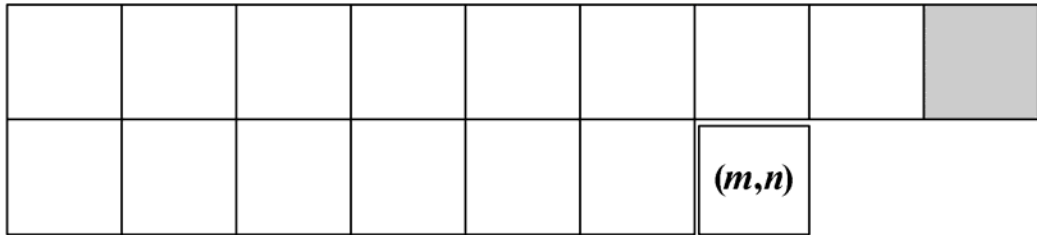
Fig. 5.3 – Suporte do tipo NSHP de dimensão 1 \times 6 \times 2 , usado nas simulações do primeiro experimento.
