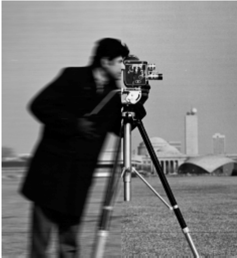
Fig. 5.7 – Imagem com lado esquerdo degradado sinteticamente com PSF do tipo movimento horizontal de câmera de dimensão 1 \times 7 e lado direito inalterado. É adicionado ruído do tipo Gaussiano para BSNR=40 dB.
