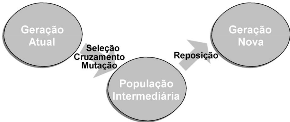
Fig. 4.5 – Ciclo básico de um algoritmo genético.
