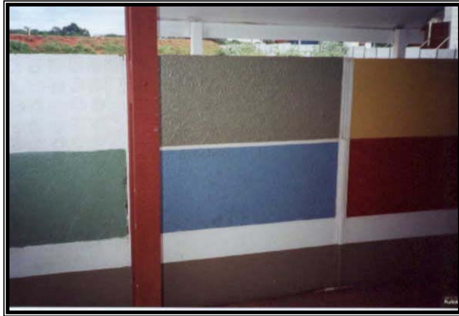
Figura 5.18 – Antecipação de realização de teste de tonalidades de tintas
