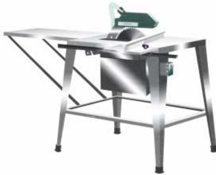
Figura 7 – Serra circular (sem fechamento lateral).
