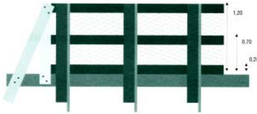
Figura 4 – Dimensões padrão de guarda-corpo (NR-18)
