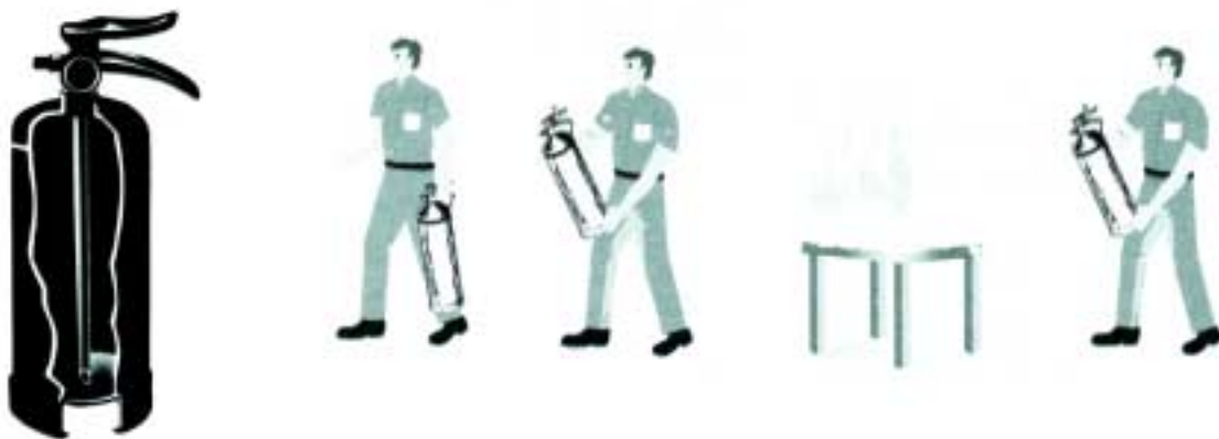
Figura 8 – Extintor de Pó Químico Seco.
