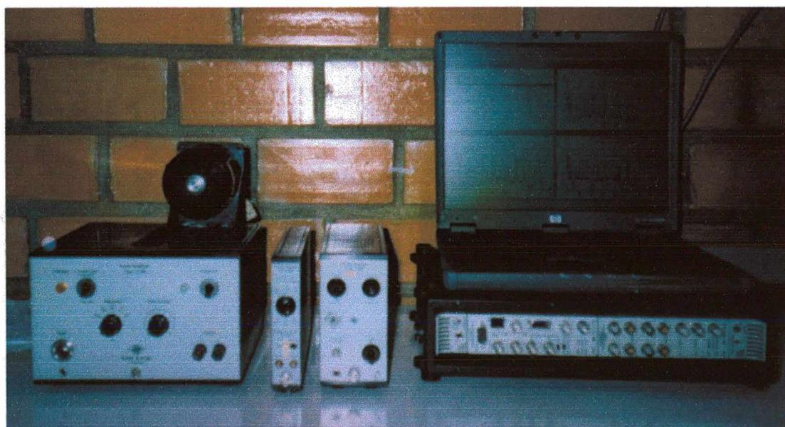
Figura 4.5 Fotografia dos equipamentos usados na análise experimental para obtenção de Função de Resposta em Frequência – Mobilidade em Placas Livre-Livre.
