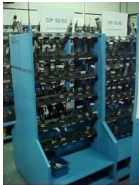
Figura 23: Sistema de armazenamento de ferramentas montadas, depois da aplicação do 5S na área de ferramentas.
