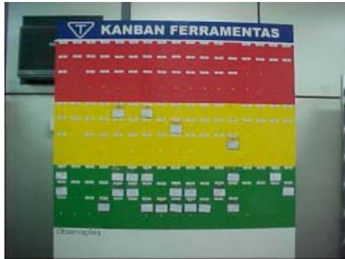
Figura 46: Quadro porta-Kanban utilizado para ferramentas percíveis da linha de blocos e cabeçotes International
