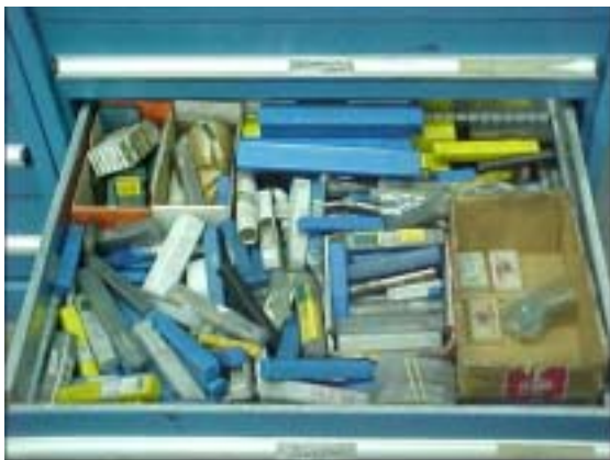
Figura 20: Sistema de armazenamento de brocas antes da aplicação do 5S na área de ferramentas.
