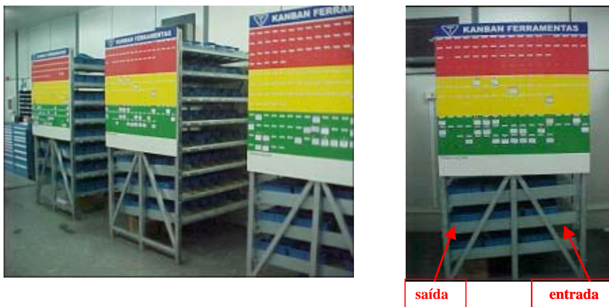
Figura 48: Prateleiras do Kanban de ferramentas de corte da linha International, respeitando o sistema FIFO
