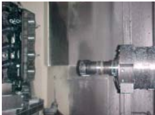
Figura 25: Ferramenta montada sendo utilizada dentro do centro de usinagem
