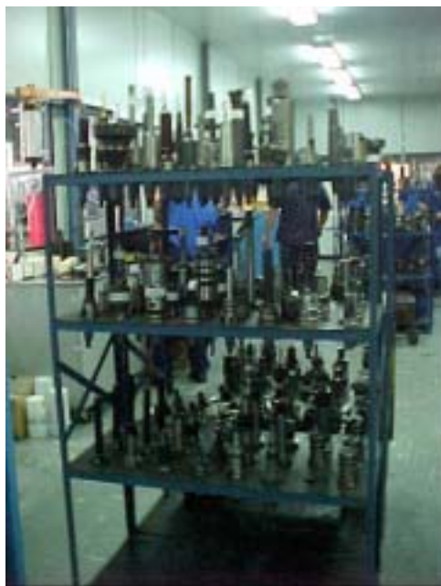
Figura 22: Sistema de armazenamento de ferramentas montadas, antes da aplicação do 5S na área de ferramentas.
