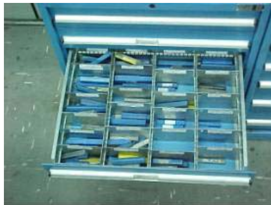
Figura 21: Sistema de armazenamento de brocas depois da aplicação do 5S e antes da aplicação do Kanban na área de ferramentas.
