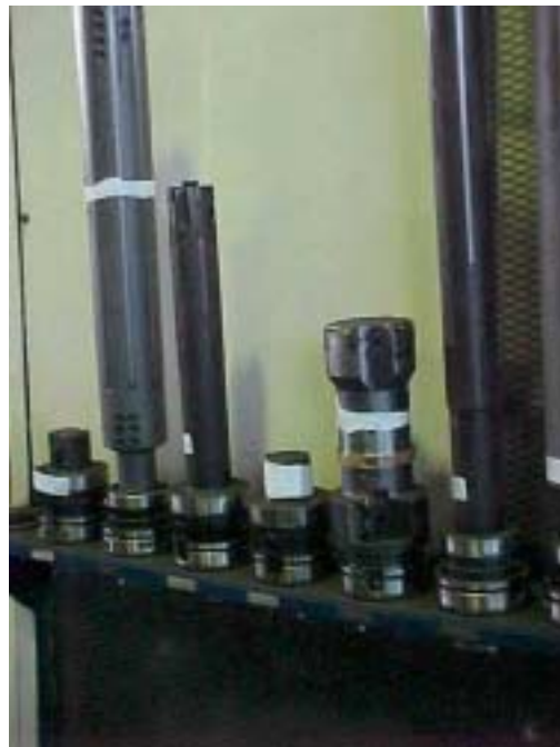
Figura 26: Ferramenta montada ao lado do centro de usinagem.
