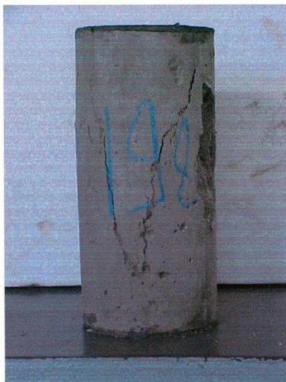
FIGURA 24 – Corpo-de-prova de concreto com 0,30% de fibras de 20mm após a ruptura
