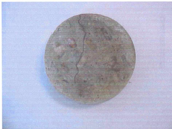
FIGURA 37 – Fissuração da parte inferior do CRF de PET (20mm / 0,30%) após 10 golpes
