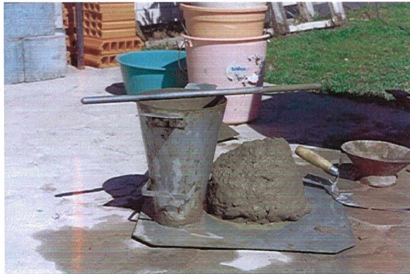
FIGURA 16 – Abatimento do concreto com 0,05% de fibras de 15mm
