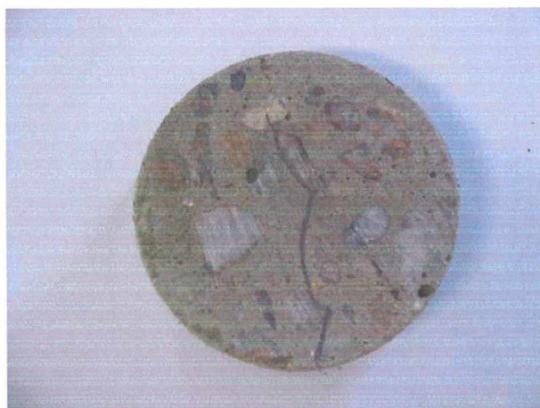
FIGURA 35 – Fissuração da parte inferior do CRF de PET (20mm / 0,05%) após 11 golpes
