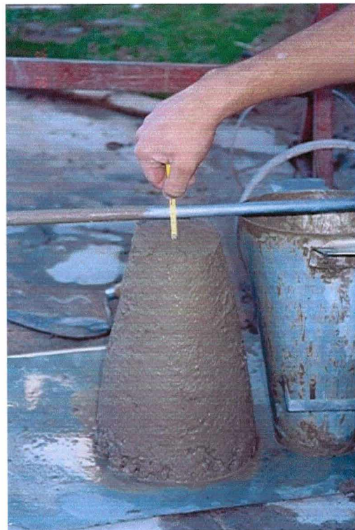
FIGURA 17 – Abatimento do concreto com 0,30% de fibras de 15mm
