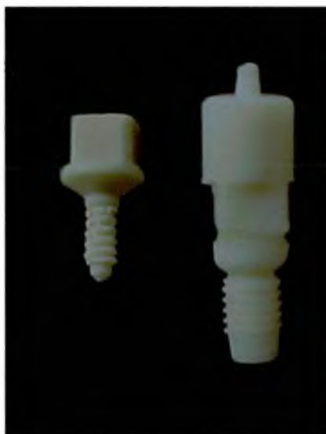
Figura 2 – Parafusos usinados em osso cortical bovino liofilizado
