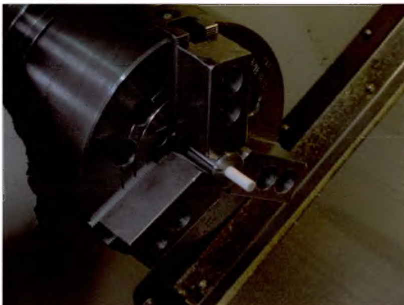
Figura 5 – Cilindro fixado na placa do torno CNC
