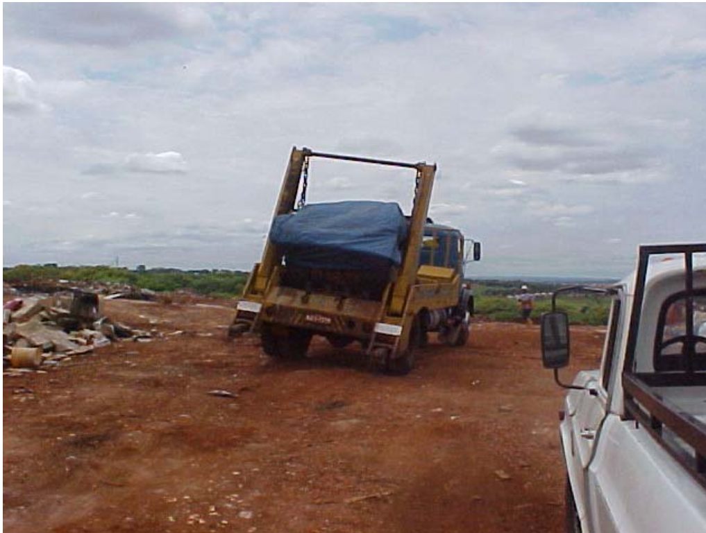
Foto 09 : Caminhão coletor com container cheio e coberto, chegando na área de depósito particular das empresas para descarga de RCD.
