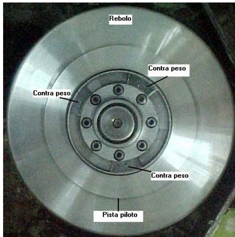
Figura 45 – Rebolo balanceado e fixado na máquina.
