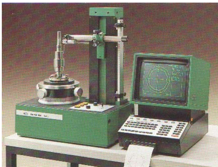
Figura 42 – Circularímetro modelo MMQ3 da Mahr & Perthen.
