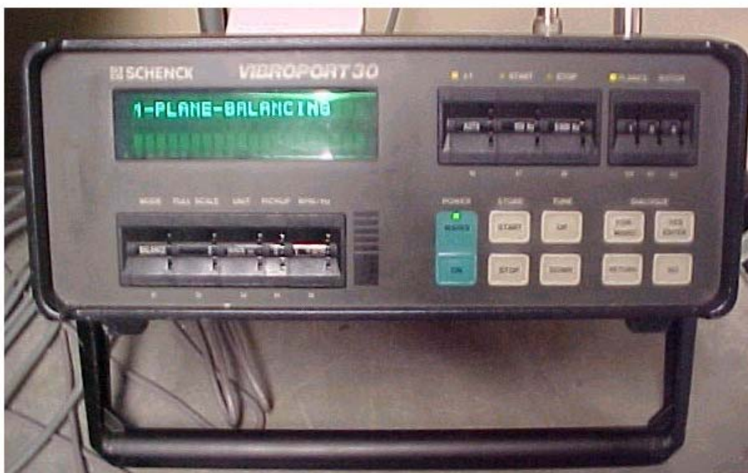
Figura 43 – Aparelho usado para medir vibrações VIBROPORT 30.
