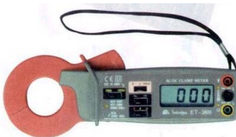
Figura 41 – Amperímetro de efeito Hall modelo ET-3800.
