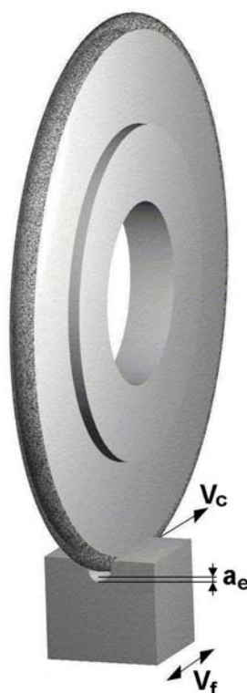
Figura 34 - Operação de abertura de canal com retífica plana.
