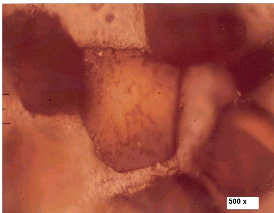
Figura 58 – Grão de CBN antes dos experimentos.
