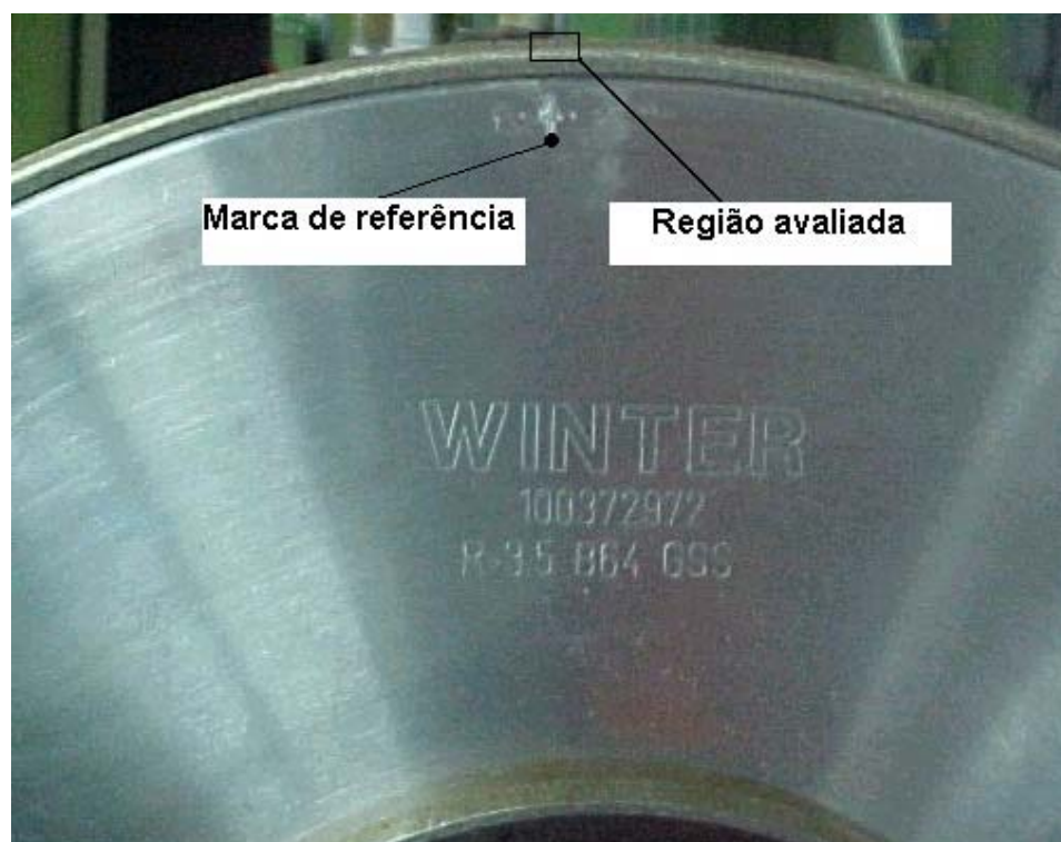
Figura 44 – Marca de referência para avaliação de micro e macro-desgaste do grão.
