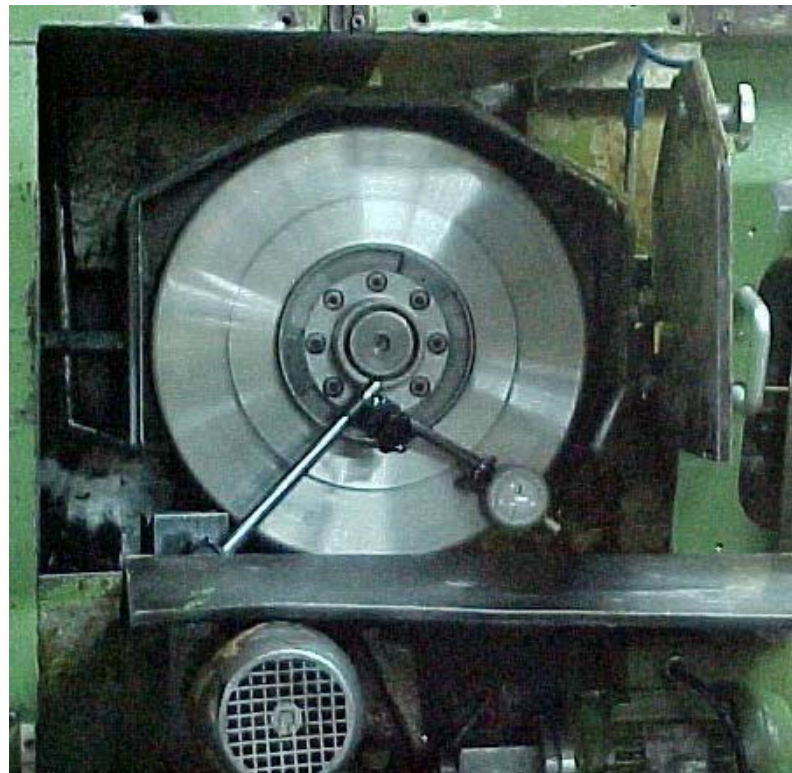
Figura 46 – Ajuste da concentricidade.
