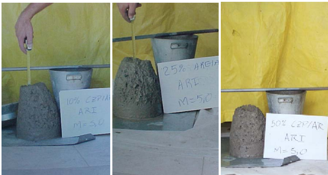
Figura 4.12 – Comparação visual dos diferentes concretos AREIA/CZP, com cimento ARI e mesmo slump: a) 10% substituição b) 25% substituição c) 50% substituição
