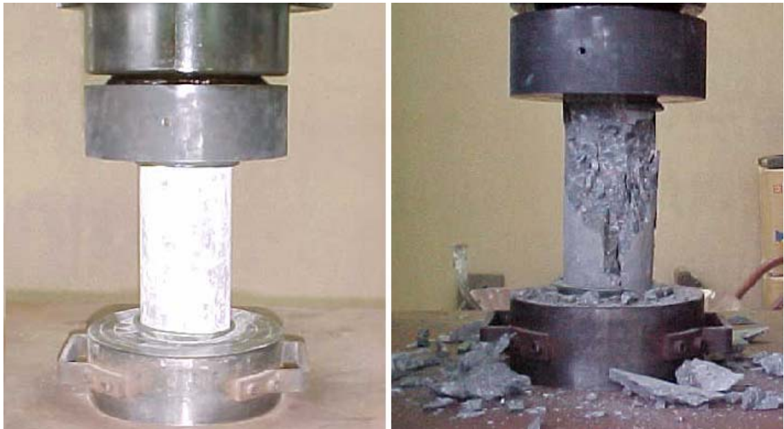
Figura 4.19 – Seqüência de rompimento dos corpos de prova: a) Corpo de prova sendo carregado b) Corpo de prova após o rompimento.
