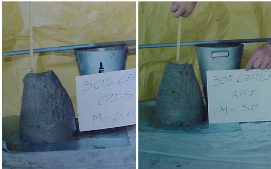
Figura 4.13 – Comparação visual dos diferentes concretos CIM/CZP com teores de 30% de substituição a) Com cimento CPI-S b) Com cimento ARI
