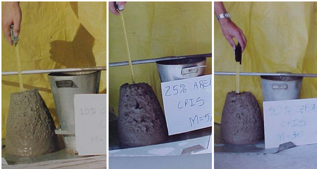
Figura 4.11 – Comparação visual dos diferentes concretos AREIA/CZP, com cimento CPI-S e mesmo slump: a) 10% substituição b) 25% substituição c) 50% substituição
