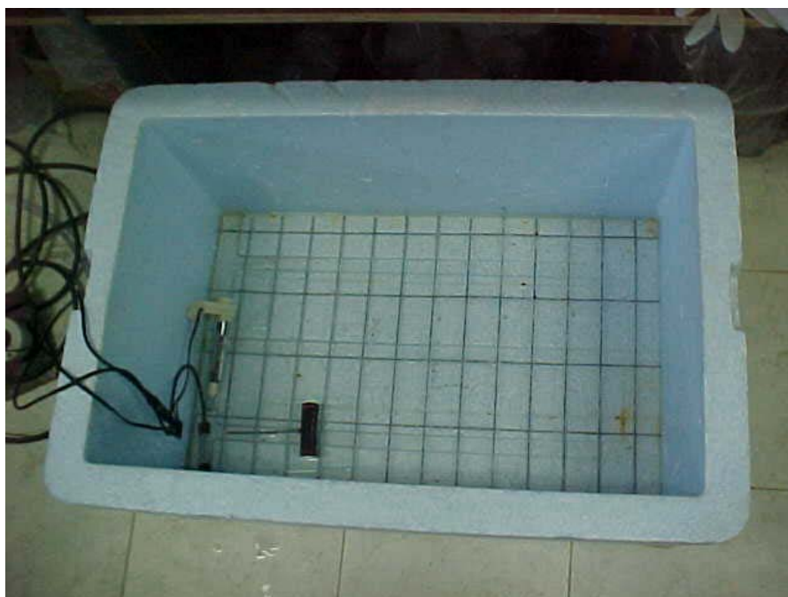
Figura 3.5– Esquema montado para o ensaio de absorção de água por capilaridade.
