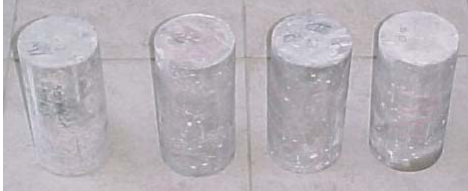
Figura 4.18 – Aspecto dos diferentes concretos: referência e com adição de cinza.
