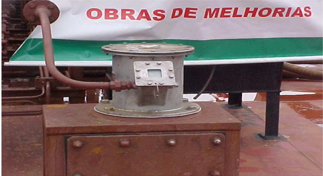
Fig.4.7 – Sonda radar de tanque de carga instalada no convés principal.
