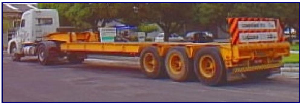
**Figura 4.3 – Prancha baixa de três eixos**
