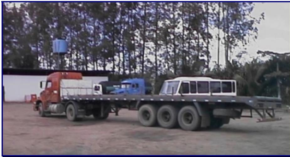
**Figura 4.2 – Prancha alta de três eixos**
