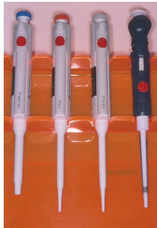
Figura 4 - Micropipetas
