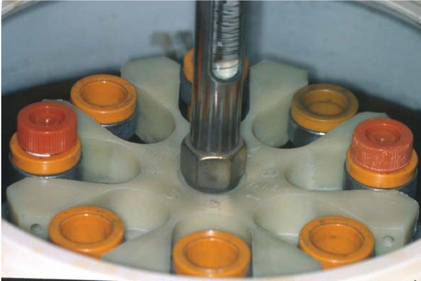
Figura 4 – Parte interna da centrífuga
