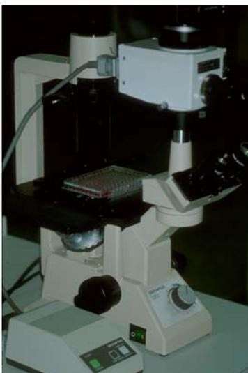
Figura 29 – Microscópio de luz invertida
