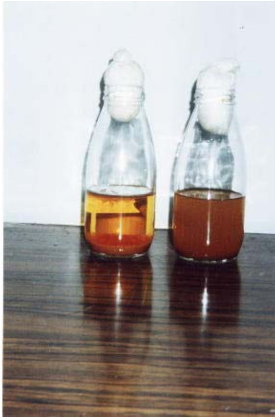
Imagem 11 - Comparação entre o suco de maçã clarificado pela ação de enzimas pectinolíticas produzidas pelos ascósporos de N. fischeri 2PC (à esquerda), e outro suco sem inoculação (controle)
