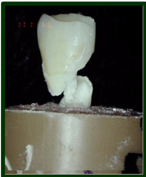
Figura 39 – Corpo de prova evidenciando a fratura no terço cervical.
