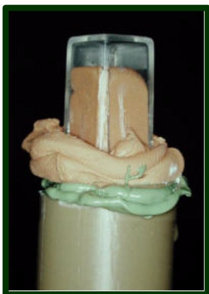
Figura 13 – moldagem do espécime com Express leve
