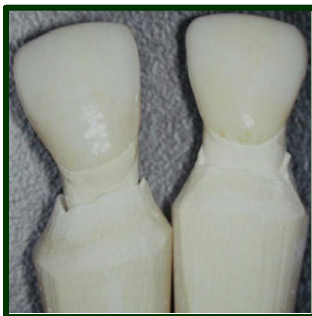
Figura 19 - Inclusão das peças com o canal de alimentação por onde foi injetada a cerâmica
