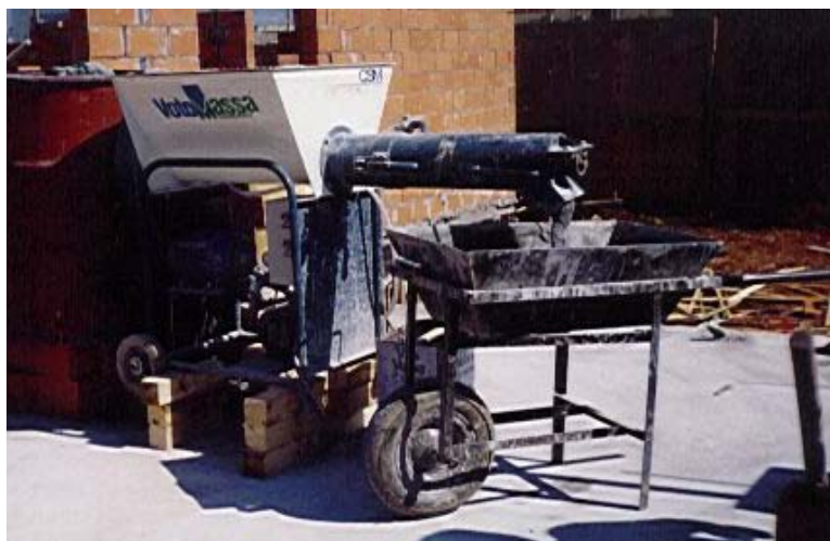
Figura 21: Argamasseira para alvenaria estrutural
