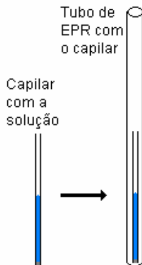
Figura 4 - Representação do sistema utilizado para as medidas de EPR.
