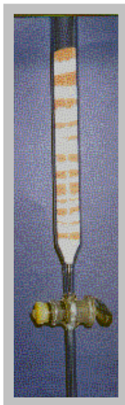
Figura 25. Filtro contendo bauxita e amido pulverizado usado para purificação dos ésteres metílicos e etílicos obtidos a partir do óleo soja refinado.
