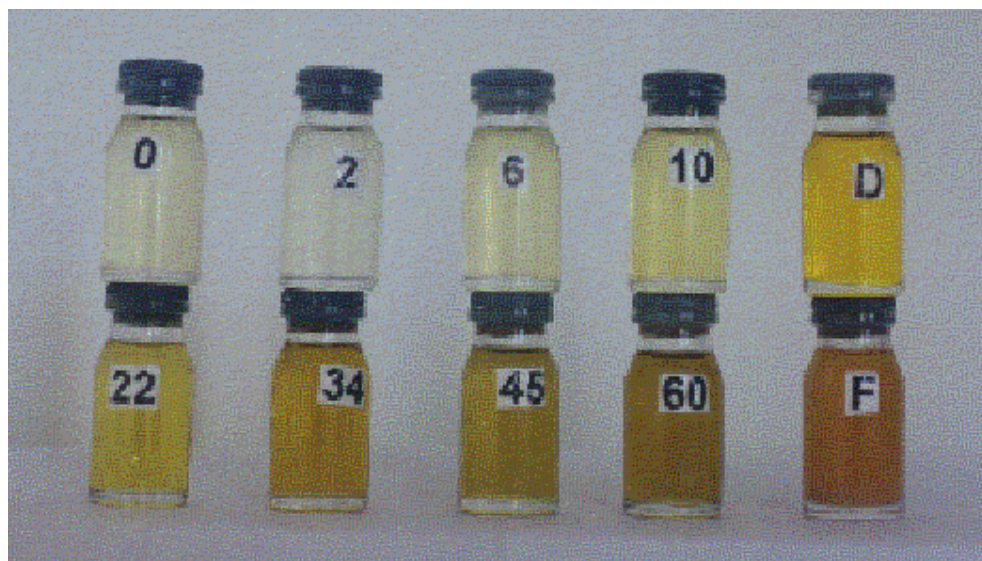
Figura 31. Fotografia mostrando a aparências dos óleos de soja não aquecido (0), do óleo aquecido por 2, 6, 10, 22, 34, 45 e 60 horas e dos óleos, degomado (D) e usado (F)
