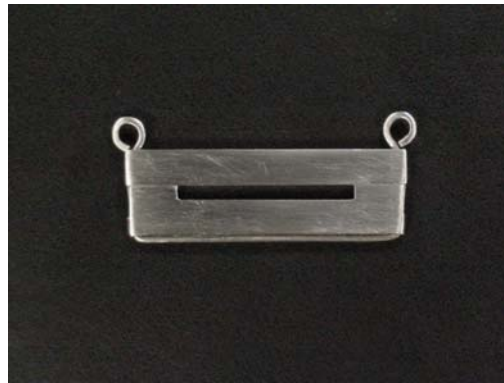
Figura 3A – Molde metálico bipartido utilizado para a confecção dos corpos de prova.
