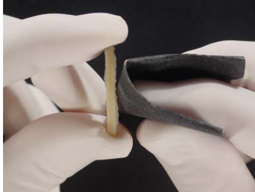
Figura 2G – Remoção dos excessos de cimento do corpo de prova com uma lixa de granulação 320.
