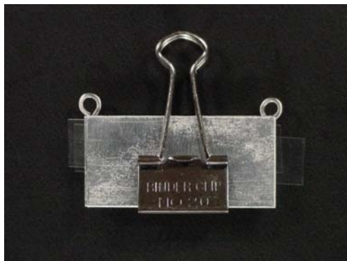
Figura 3E – Grampo prendendo firmemente o conjunto lâminas de metal / molde.
