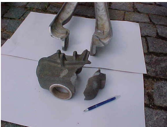
Figura 2-15 – Garfo e capacete quebrados.
