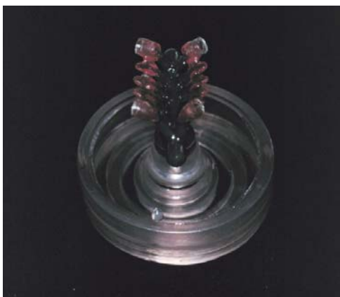
Figura 6A – Duas estruturas unidas aos canais de alimentação.
