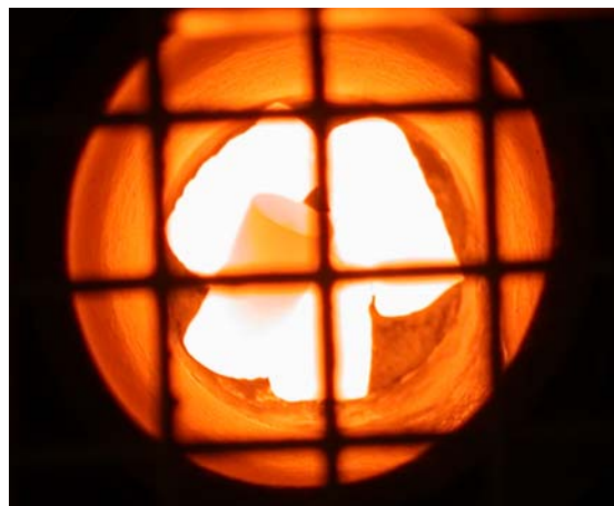
Figura 7C – Fusão da liga de Níquel-Cromo por indução em alta frequência.
