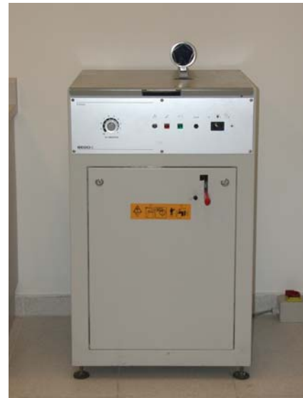
Figura 7B - Máquina de fusão por indução em alta frequência.
