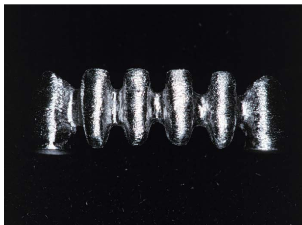
Figura 10 – Estrutura metálica usinada.
