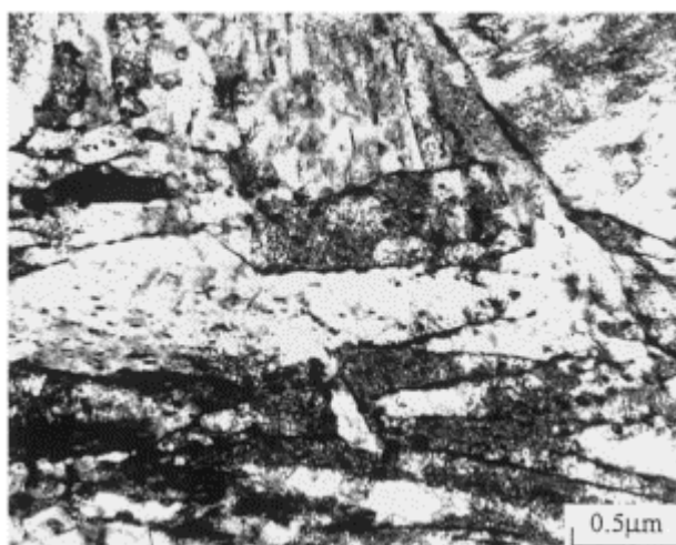
Figura 3.5 – TEM Micrografia de um corpo de prova temperado em óleo ( 850^\circ\text{C}/30\text{min} ) e revenido a 200^\circ\text{C} por 2 horas. [Lee e Su]
