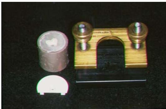
Figura10- Peças utilizadas para a confecção dos corpos de prova.
