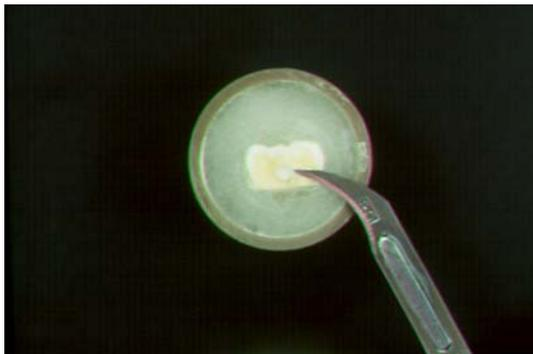
Figura 16- Remoção dos excessos de adesivo com lâmina de bisturi nº 12.
