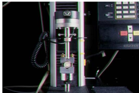
Figura 21- Máquina de ensaio universal INSTRON utilizada nos testes, com a lâmina de cisalhamento e corpo de prova posicionados.
