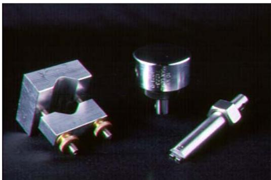
Figura 20- Peças utilizadas no ensaio de cisalhamento.
