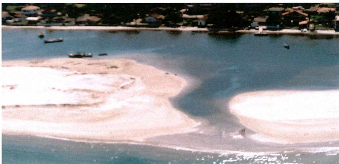
Foto (3). Canal de desembocadura da Laguna de Ponta das Canas, aberto através de dragagem executada pela CIDASC, em março de 1998. Observa-se o expressivo assoreamento do canal, uma semana após a dragagem. Fonte: FATMA.
