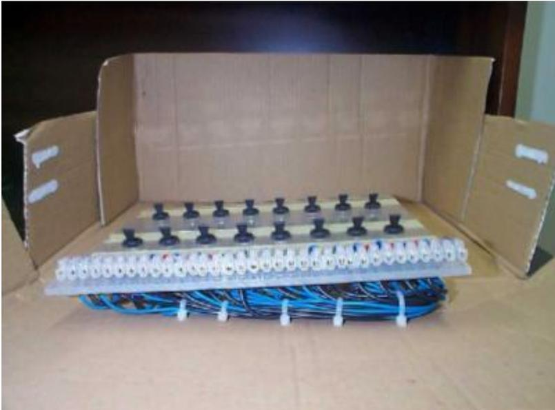
**Fig. 3.5\_ Foto da placa de acionamento para conexão dos termopares.**
