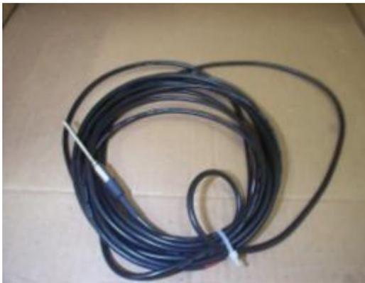
Fig. 3.3 Foto do termopar
