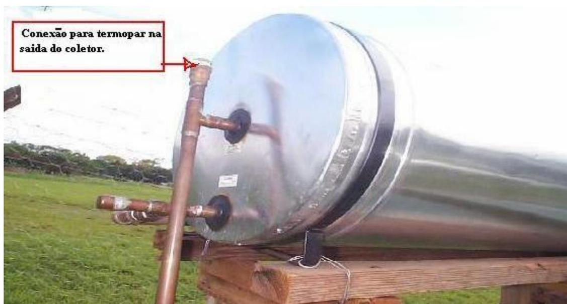
Fig.3.12 – Foto do detalhe da conexão para termopar.
