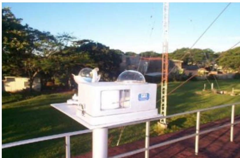
**Fig. 3.10 Foto do Actinógrafo (piranógrafo)**
