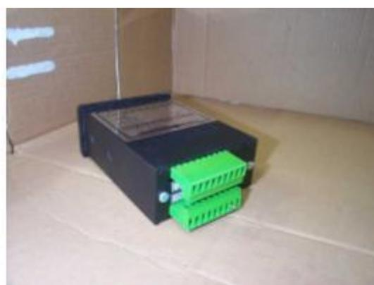
Fig. 4.4 Foto do Indicador digital, entradas.
