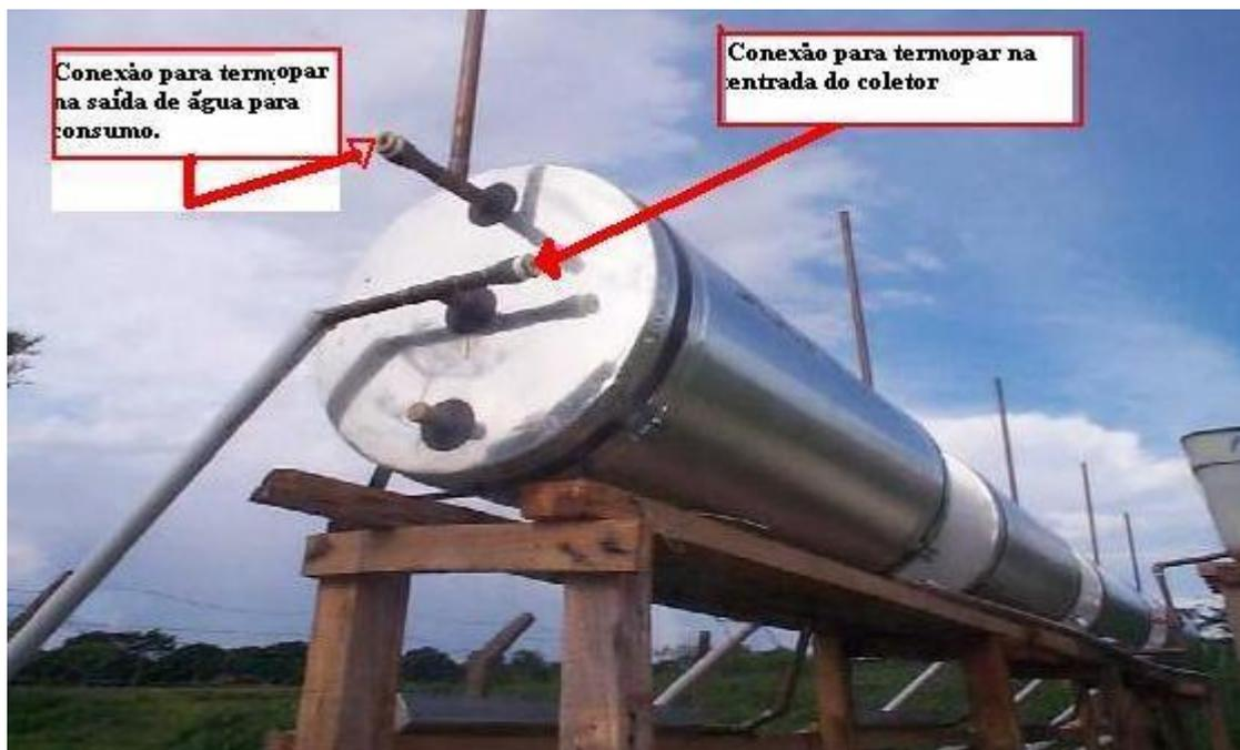
**Fig.3.13 – Foto do detalhe das conexões para termopar.**
