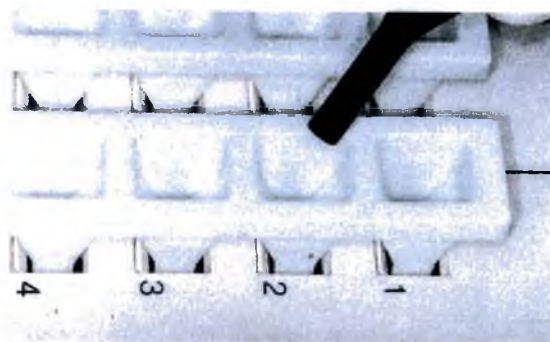
Figura 35- Colocação da bilha metálica nas cuvetas.
