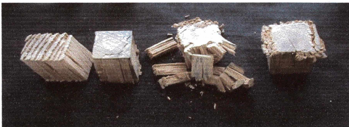
Figura 32: fraturas típicas observadas em eucalipto. Da esquerda para direita, inclinada, fendas, catastrófica e esmagamento
