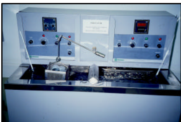
Figura 41 - Máquina de termociclagem com dentes na temperatura de 55°C
