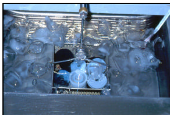
Figura 41 - Máquina de termociclagem com dentes na temperatura de 55°C
