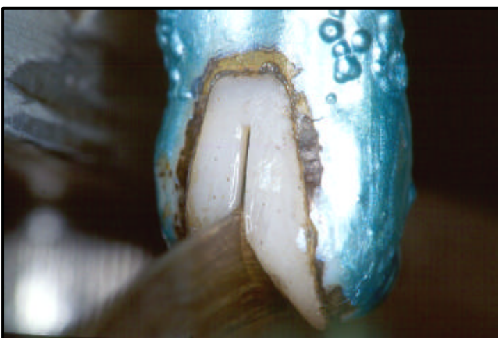
Figura 44 - Disco de diamante seccionando corpo de prova para iinfiltração
