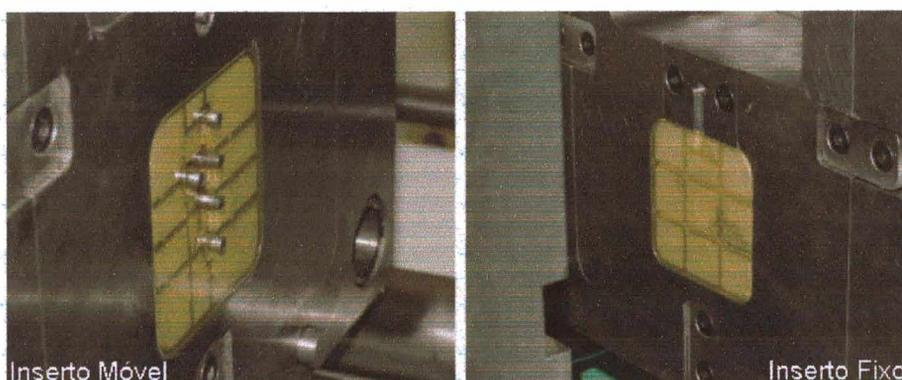
**Figura 16:** Insertos montados no porta-molde e posicionados na máquina injetora.
