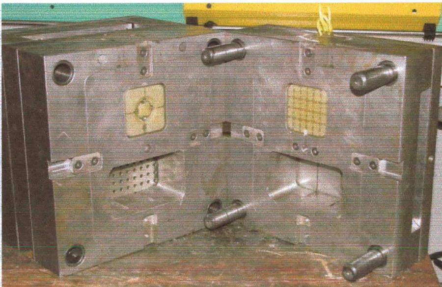
**Figura 31:** Molde aberto com os insertos instalados.
