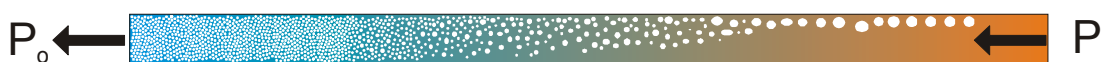
Figura 1.5 – Esquema do escoamento da mistura óleo e refrigerante em duto reto (Lacerda, 2000).
