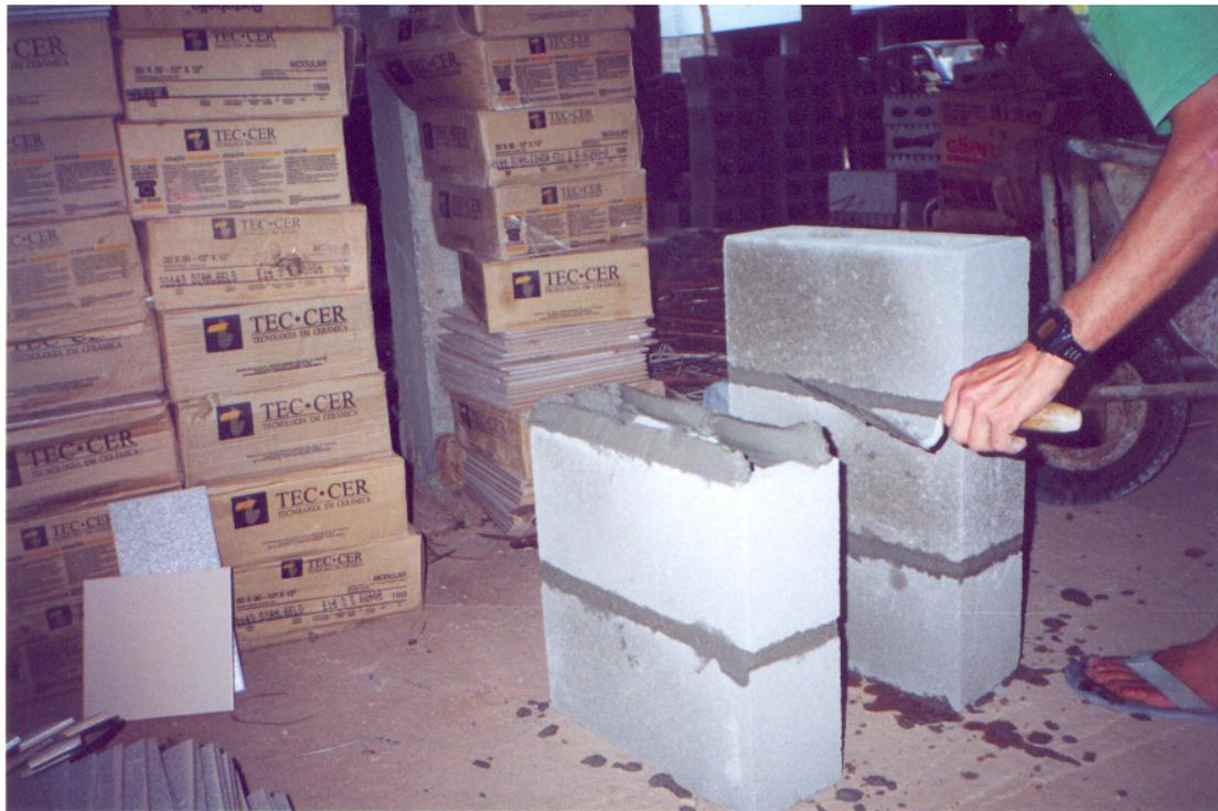
Figura 3.15 – moldagem dos prismas com assentamento lateral (Obra 13).
