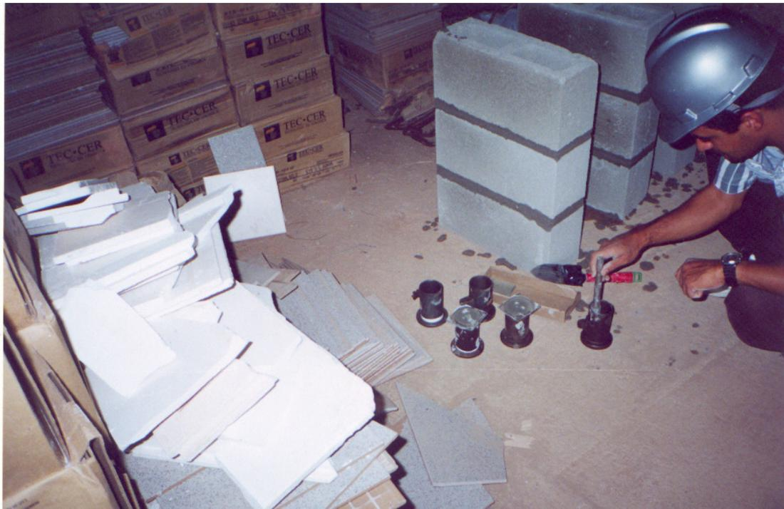
Figura 3.10 – Moldagem dos corpos de prova de argamassa (Obra 13).
