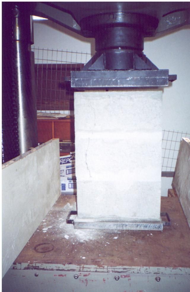
Figura 3.14 – Ensaio de ruptura de prisma.
