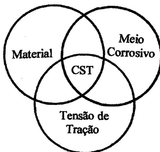
FIGURA 2.1- Conjunção de fatores para gerar trincas de corrosão sob tensão (Denny, 1996).
