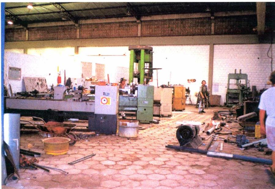
**Figura 05. Tipo de piso ineficiente para metal-mecânicas**
