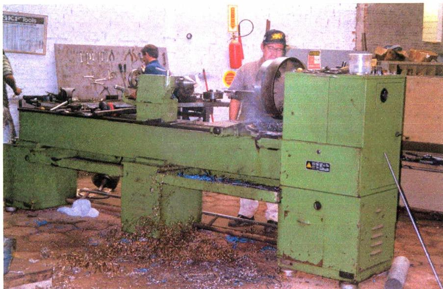
**Figura 06. Disposição de cavacos numa pequena indústria metal-mecânica**
