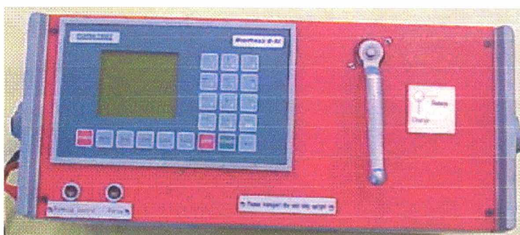
Figura 3.4 – Equipamento para aquisição de dados, programação do ensaio e controle de aplicação de carga.
