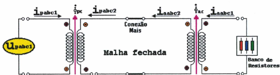
Figura 6.2.2.1 - Partida da MATBCDA com Uma Resistência Externa Ligada ao Estator da Máquina Auxiliar
