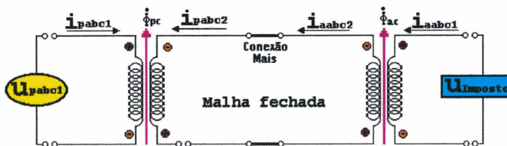
Figura 6.2.3.1 - Tensão Imposta ao Estator da Máquina Auxiliar da MATBCDA
