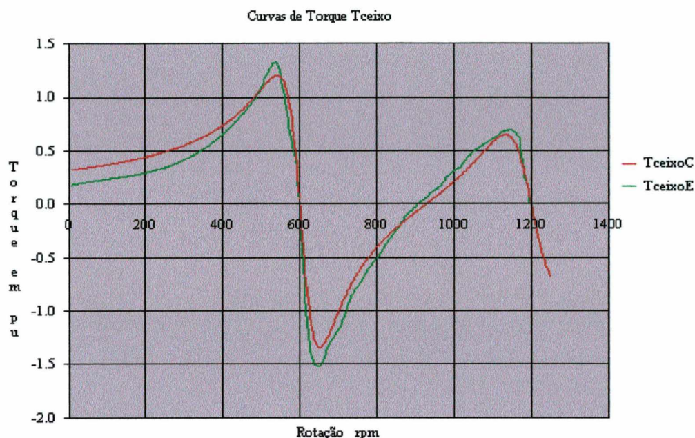
Figura 7.3.1.9 - Torque no Eixo da MATBCDA Calculado [Tceixo] Comparado com o Valor Ensaiado.
