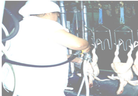
Figura 8: Toaleta da Cloaca.
