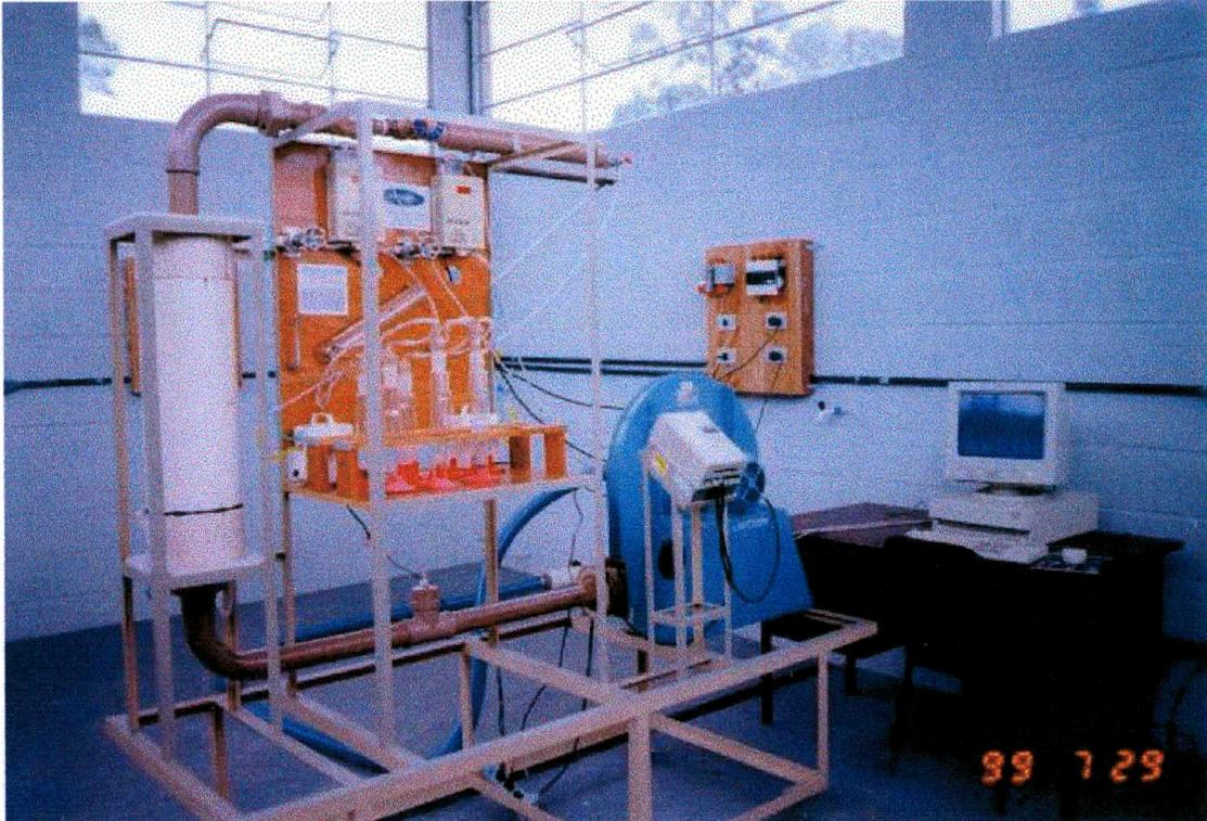
**Figura 14: Foto do biofiltro-piloto**
