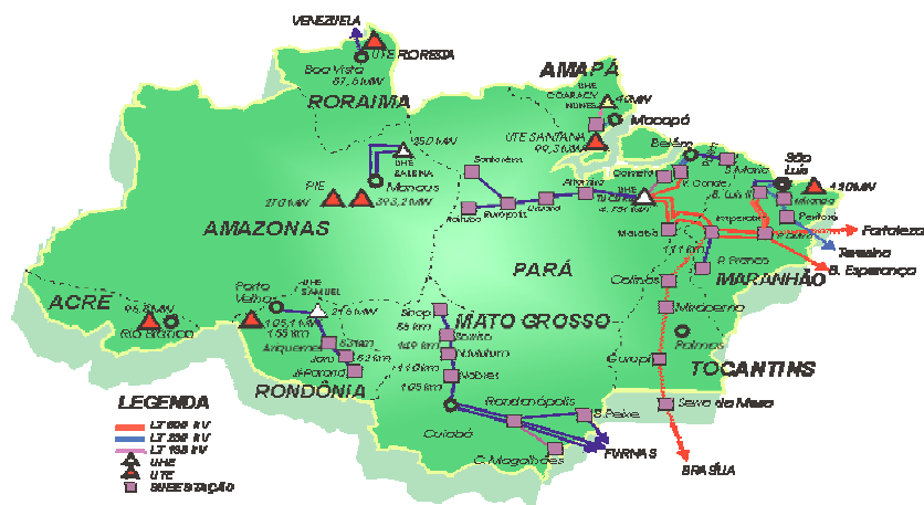
Figura 1.1 - Mapa da rede de geração e transmissão de energia elétrica gerenciadas pela ELETRONORTE, nota - se que os sistemas não se limitam aos estados da Região Norte 1
