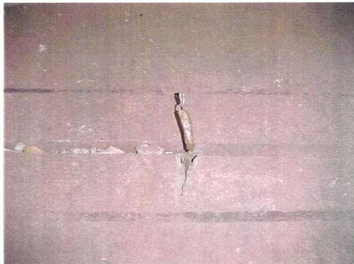
Figura 5.4 – Fotografias mostrando a instalação dos termopares para medição da temperatura do piso e dos gases sob as vagonetas.
