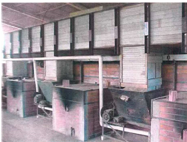
Figura 3.2 – Fotografia mostrando as fornalhas, os alimentadores de serragem e o sistema de insuflamento de ar.
