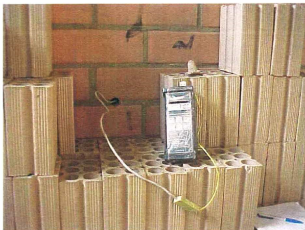
Figura 5.2 – Fotografia mostrando a medição da temperatura dos gases no canal lateral e no túnel de passagem da carga.
