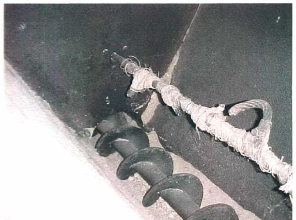
Figura 3.3 – Detalhe mostrando o interior da caixa do alimentador de serragem.
