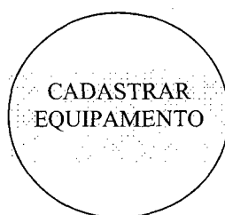
Figura 4 Componente da representação gráfica de DFD - PROCESSO, modificado de [YOURDON, 1992].
