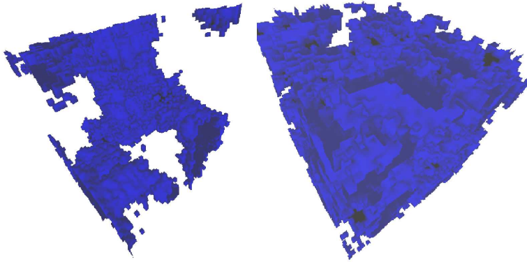
Figura 4.16: Visualização 3D de representação do Berea 500, gerada com gaussiana truncada.
