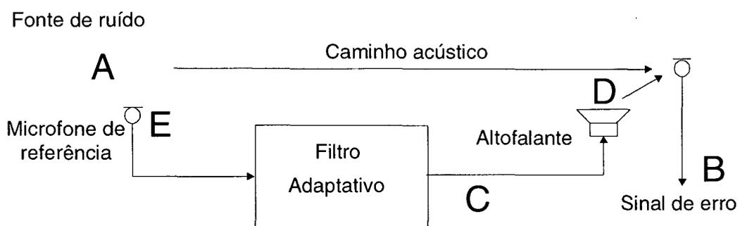
Fig. 2.1. Diagrama esquemático para o caso de controle de ruído acústico.
