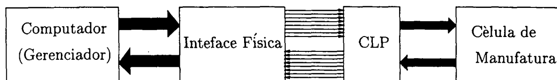
Figura C.2: Esquema de interligação do Computador com a célula de manufatura
