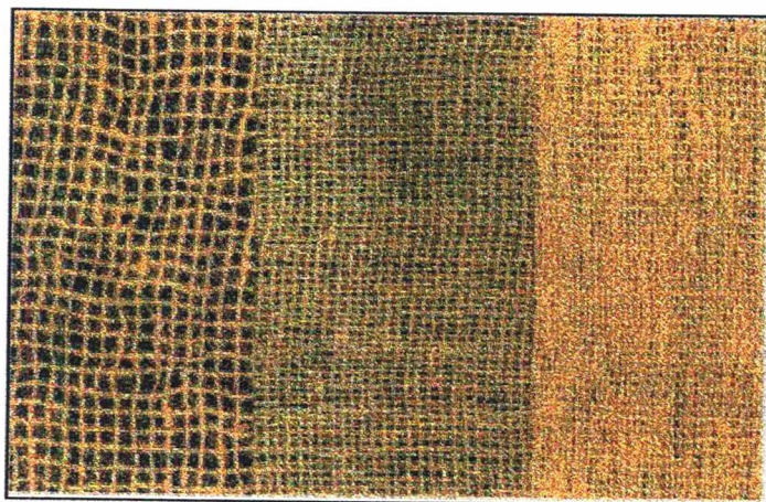
Foto 7: Geotêxteis em diferentes estruturas.
