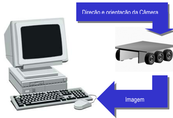
Fig. 5.8 – Esquema de transmissão de dados entre o Computador e o RAU
