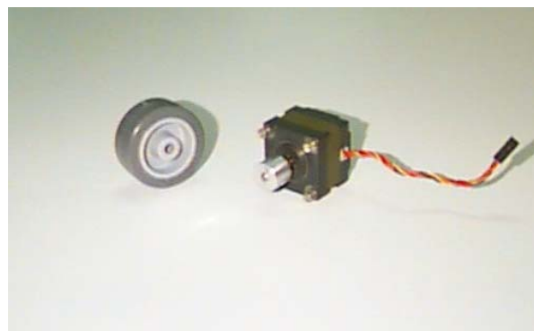
Fig B.2 – Roda e motor de passo do RAU
