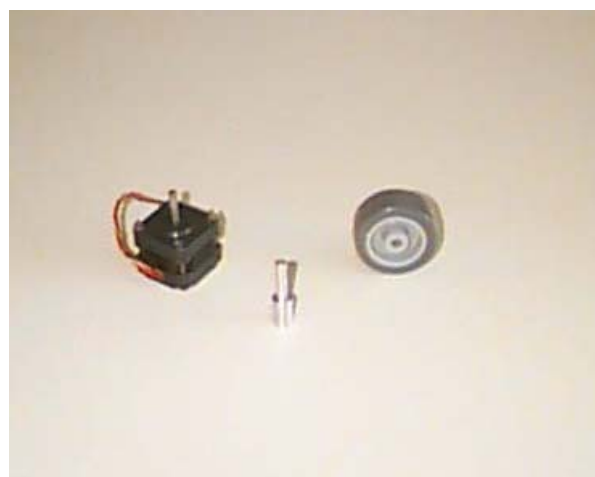
Fig B.3 – Roda, motor de passo e bucha de montagem
