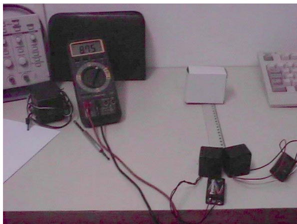
Fig. B.10 – Teste de sensibilidade dos sensores infravermelhos
