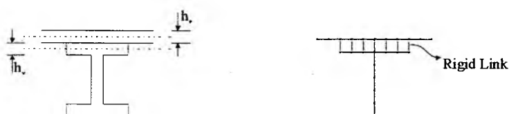
Figura 4.2 – Utilização de elemento rígido de ligação na união da placa com a aba da viga
