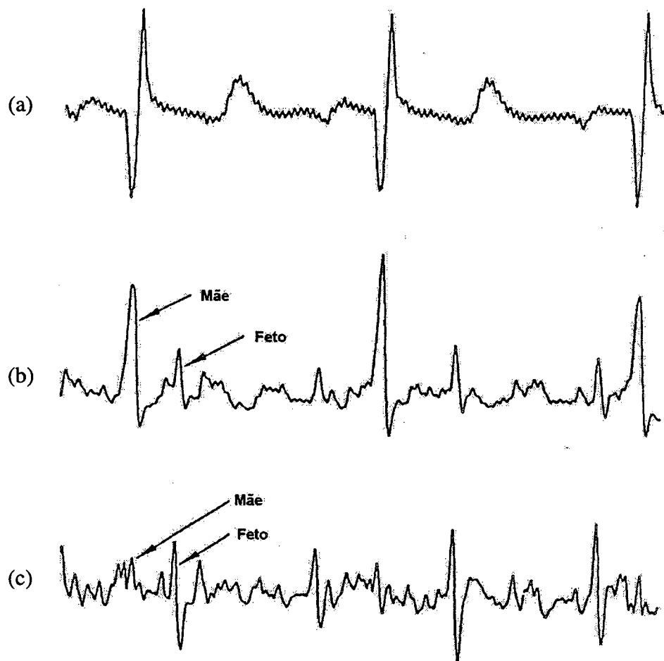
Figura 3.4 - (a) Sinal de referência tomado nos eletrodos sobre o tórax materno, (b) sinal de entrada registrados nos eletrodos sobre o abdômem e (c) sinal de saída.
